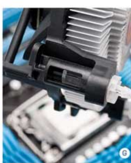
E. အဆင့် 8 : CPU ပေါ်က အချိန်တွေနဲ့ socket က အထစ်တွေ အံဝင်ခွင် ကျရှိအောင်ချိန်ပြီး CPU ကို socket အတွင်း တပ်ဆင်ပါ F. အဆင့် 11 : CPU မျက်နှာပြင်ပေါ်မှာ thermal compound နည်းနည်း သုတ်ပါ G. အဆင့် 12 : Heat-sink အထိန်းတွေကို လှည့်ပြီးဆွဲမထားပါ
