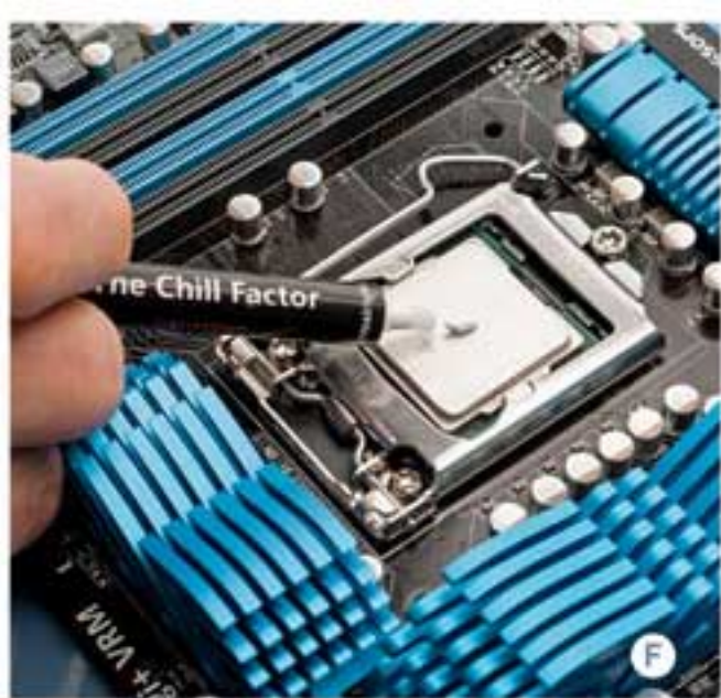
E. အဆင့် 8 : CPU ပေါ်က အချိန်တွေနဲ့ socket က အထစ်တွေ အံဝင်ခွင် ကျရှိအောင်ချိန်ပြီး CPU ကို socket အတွင်း တပ်ဆင်ပါ F. အဆင့် 11 : CPU မျက်နှာပြင်ပေါ်မှာ thermal compound နည်းနည်း သုတ်ပါ G. အဆင့် 12 : Heat-sink အထိန်းတွေကို လှည့်ပြီးဆွဲမထားပါ
