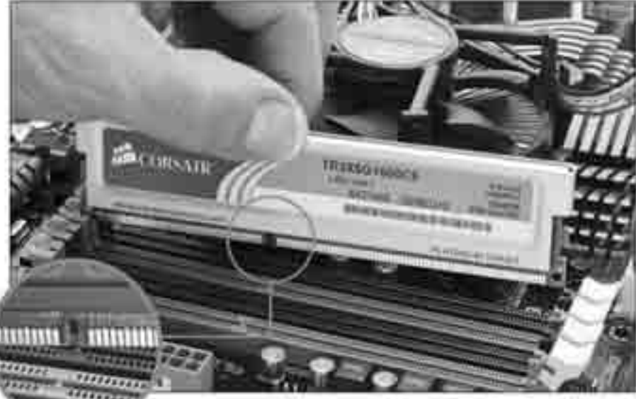
Module အဟောင်းကိုဖြုတ်ဖို့ အထိန်းမောင်းတွေကိုဖိပါ။ Module အသစ်ရဲ့ အချိန်နဲ့ socket ရဲ့ အထစ်လေးတစ်တန်း တညှိရှိအောင် ချိန်ပြီး ဖိသွင်းပါ။
