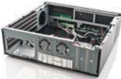
nMediaPC 1000B က Micro ATX motherboard ကို လက်ခံနိုင်ပြီး full-height graphic card ကို လက်ခံနိုင်ကာ storage bay ကလည်း ဖြတ်ရ ၊ တပ်ရ လွယ်ပါတယ်
