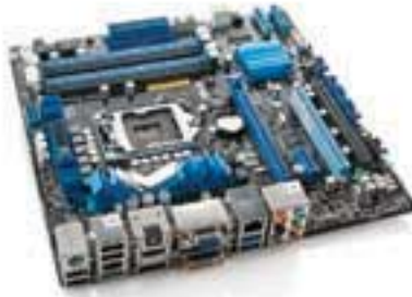
Asus ရဲ့ P8H67-M EVO motherboard မှာ memory socket ၄ ခုနဲ့ USB port အများအပြားပါလို့ PCIe slot တွေနဲ့ ချဲ့သုံးနိုင်ပါတယ်
