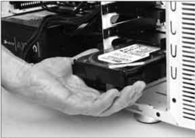
ကိုယ့်ရဲ့ drive ကို ရွေးချယ်ပြီးတာနဲ့ drive bay ထဲကို ထည့်သွင်းတာဟာ ဂိုဏ်းပေးမယ့်လည်း အဲဒီနေရာမှာ မြဲမြံစွာရှိရလားဆိုတာ သေချာအောင်ပြုလုပ်ရပါ မယ်။
